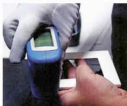
Il controllo qualità dei pezzi viene eseguito con l'ausilio di apposita strumentazione. Nella foto: controllo opacità con glossmetro.
