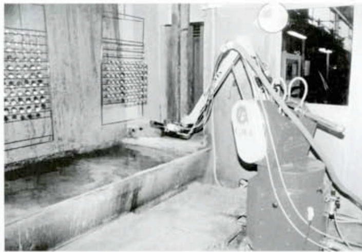
Fig. 5 - Il robot durante l'operazione di spruzzatura sui pezzi appesi ai telai di trasporto
