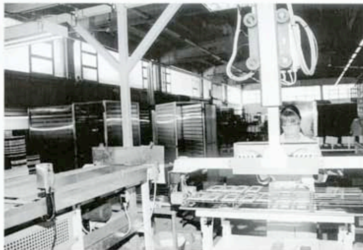
Fig. 12 - Le placchette vengono infine controllate e inscatolate
