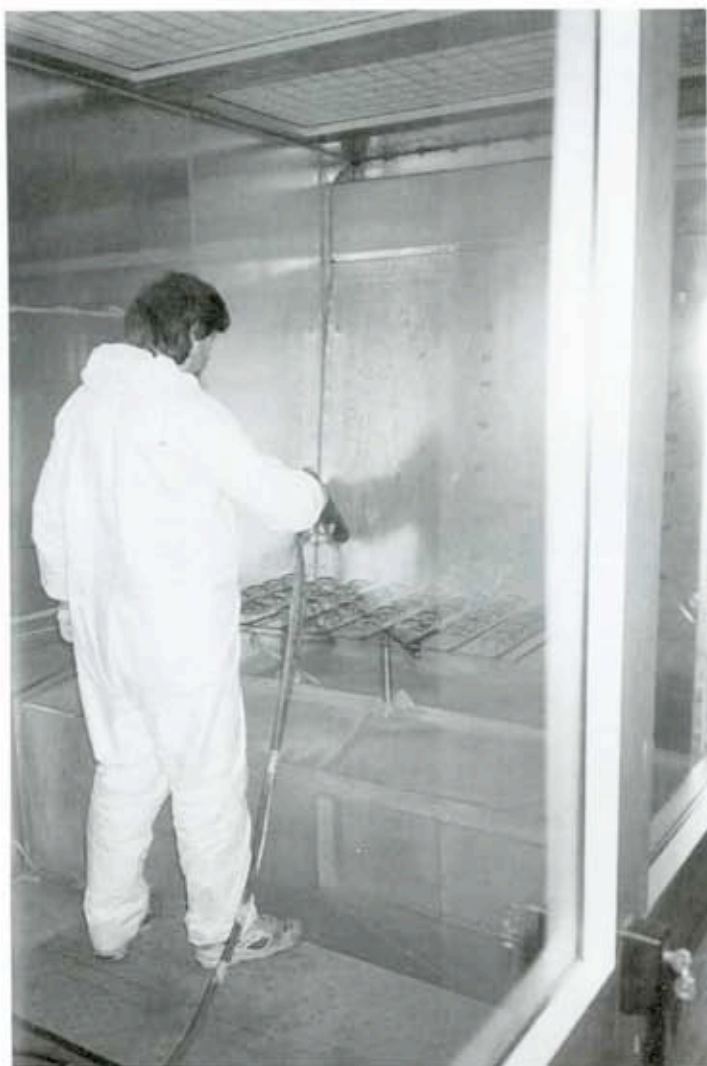
Fig. 3 - Particolare dell'applicazione manuale di vernici trasparenti
