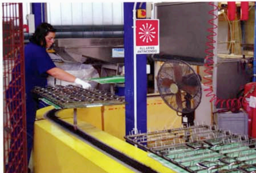
3 - La fase di carico su telai: qui il trasportatore è rovesciato e corre a pavimento.
